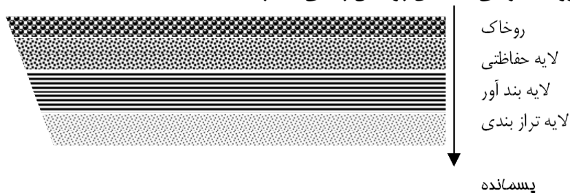
شکل ۶-۳- پروفیل عرضی لایه‌های پوشش پایانی خاکچال
